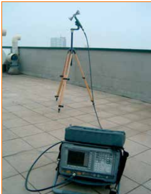
Fig. 2 Strumentazione per misure a banda stretta - analizzatore di spettro e antenne
