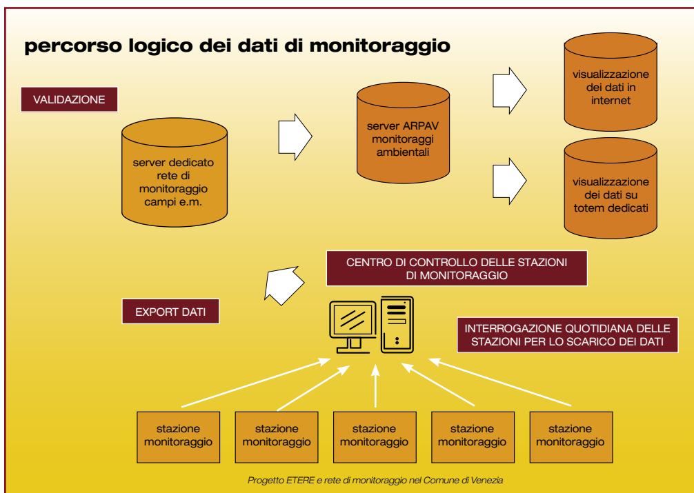
Fig. 3 Architettura della rete di monitoraggio e percorso logico dei dati
